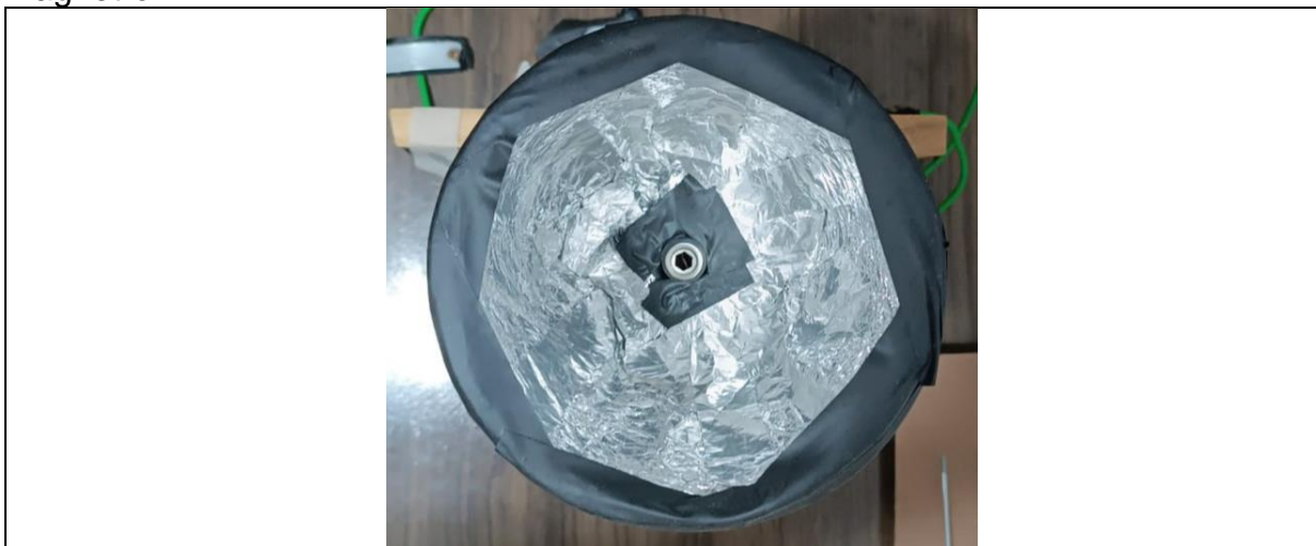
Figura 28 – Visão superior interna da guia de ondas, em seu centro a antena do magnetron.
