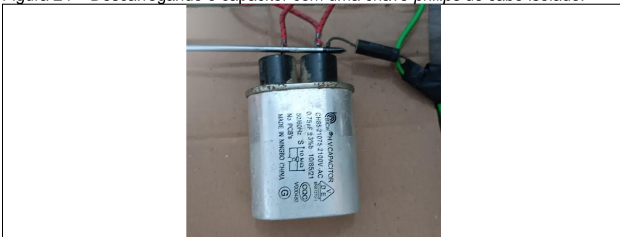
Figura 24 – Descarregando o capacitor com uma chave philips de cabo isolado.
