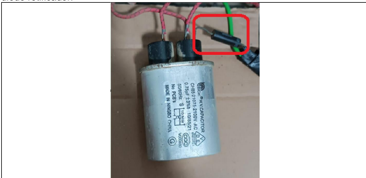
Figura 23 – Capacitor de forno micro-ondas, dentro do retângulo em vermelho o seu diodo retificador.
