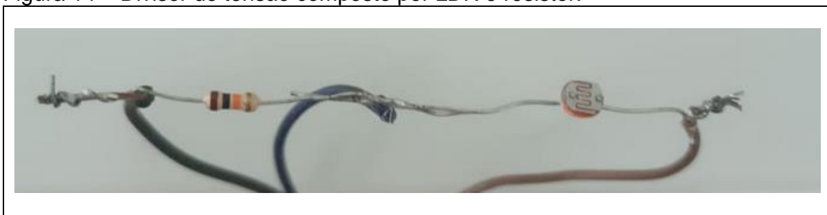
Figura 14 – Divisor de tensão composto por LDR e resistor.
