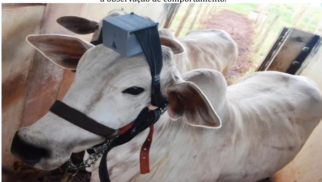
Figura 3. Dispositivo eletrônico para avaliar a frequência respiratória, a temperatura corporal e a observação de comportamento.
