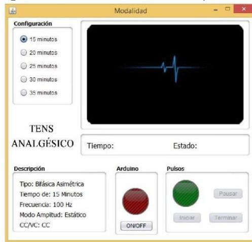
Una vez seleccionado el tiempo de configuración, se procede a encender el Arduino Uno desde la aplicación, teniendo como resultado que el indicador led de la pantalla cambia de apariencia a modo encendido.
