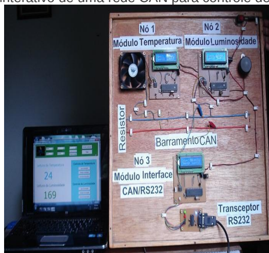
Figura 20: Painel didático e interativo de uma rede CAN para controle de temperatura e luminosidade.
