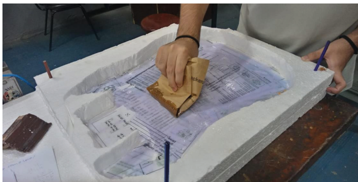
Figura 20 - Aplicação da resina.
