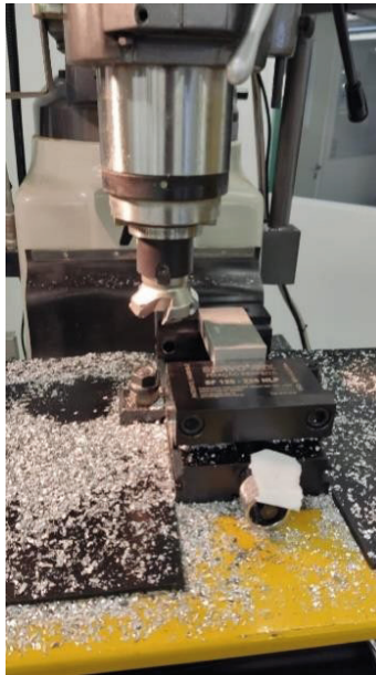
Figura 25 - Processo de usinagem do bloco de alumínio.
