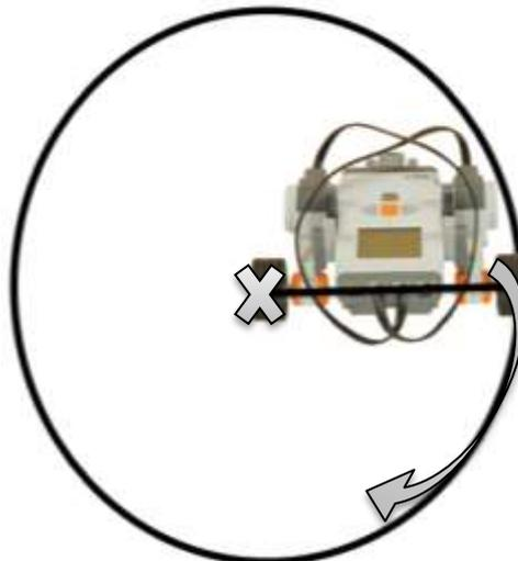
Lembrando que, buscamos saber quantos  $\alpha$  graus são necessários o motor girar para que o carrinho faça um giro de  $\beta$  graus. Vamos analisar o caso em que o carrinho faz um giro sobre uma das rodas. Quando o robô girar  $\beta$  graus ele andar  $C$  centímetros sobre a circunferência que ele descreveria caso girasse  $360^\circ$  (Figura 16).
