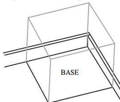
O Campo de Missões (Figura 3), em sua forma retangular, possui  $1,15\text{ m}$  de largura e  $2,35\text{ m}$  de comprimento, ou seja, seus lados delimitam uma região de  $2,7025\text{ m}^2$ . A Base em formato cúbico, de  $30\text{ cm}$ , do Campo de Missões ocupa uma região de  $0,09\text{ m}^2$ , restando uma área de  $2,6125\text{ m}^2$  na qual são dispostas todas as missões.
