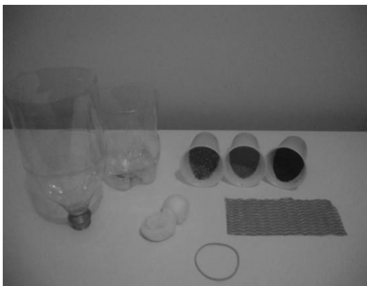
Foto 5 – Materiais para construção do filtro.
