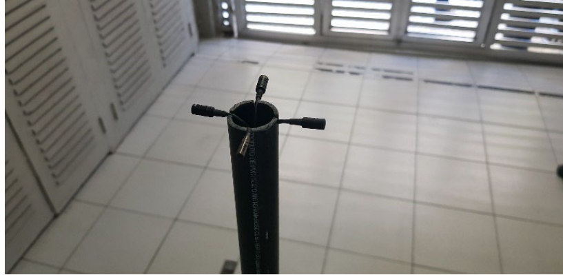
Figura 30: Protótipo de microfone ambisônico para captação de áudio multidirecional para Realidade Virtual, ACERP
