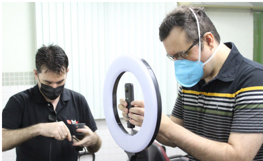
Figura 34: Montagem de equipamento auxiliar de iluminação em volta da Câmera InstaVR One X2.
