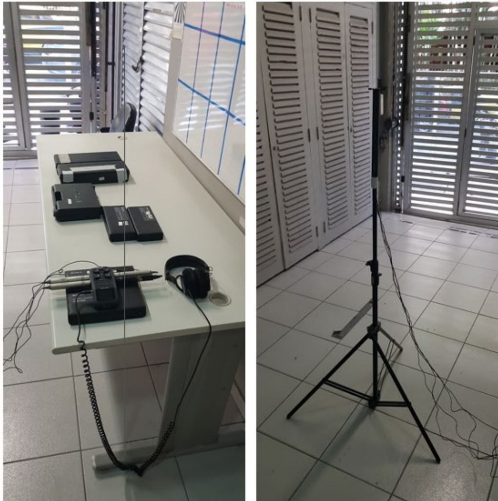
Figura 32: Protótipo de microfone ambisônico montado e pronto para gravação de áudio multidirecional para Realidade Virtual, ACERP
