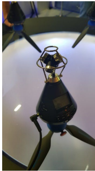
Figura 27: Microfone Ambisônico multidirecional para captura de áudio em várias direções, IBC – Holanda 2017.
