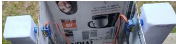
Figura 17 – Acoplamento dos braços robóticos ao tronco robótico.
