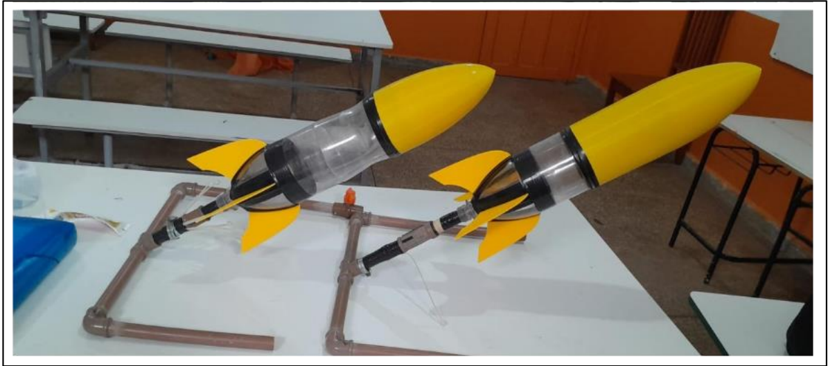
Figura 18 – Foguetes com coifas e aletas em impressão 3D
