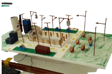
Figura 1: Maquete para medir a altura da água nos canais de Belém.
