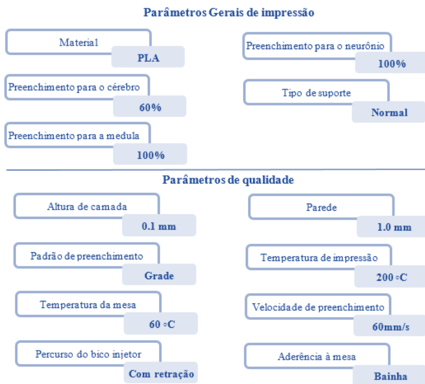
Figura 2: Parâmetros de impressão 3D.
