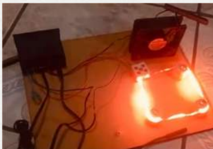
Figura 7: Resistência de chuveiro e um ventilador será feito com um Cooler.
