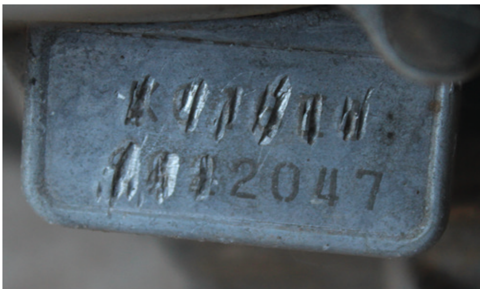
Figura 05. Identificação macroscópica ampliada da sequência alfanumérica original subjacente presente no motor (KC16E19022047).
