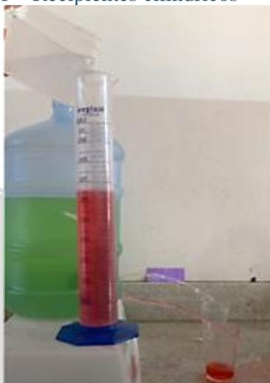
Na imagem podemos observar os dois recipientes cilíndricos posicionados lado a lado. Vemos o jato de água enchendo o copo de 265 ml, o corante alimentício na água auxilia na visualização do nível da água para cronometrar o tempo que leva para encher ambos os copos.
