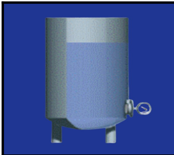
Figura 5 - Medidor de nível por pressão diferencial em tanques abertos
