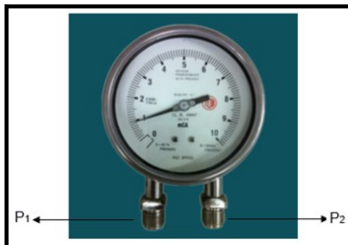
Figura 12 – Manômetro de Pressão Diferencial
