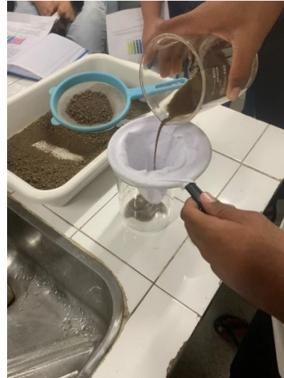
Figura 09: Filtração da solução
