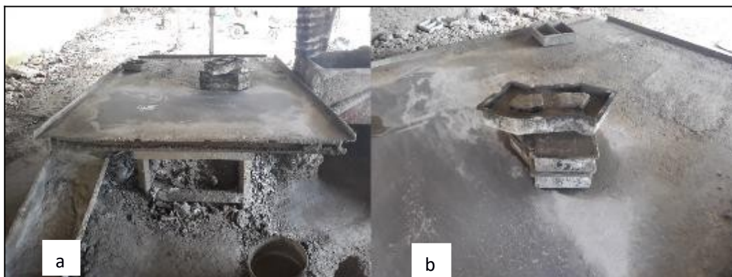
Figura 4.14 – Adensamento das peças na mesa (a) e peças adensadas em pilhas (b).
