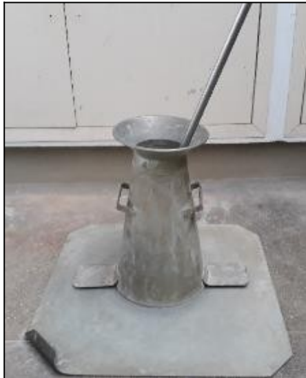
Figura 3.9 – Aparelho do slump test
