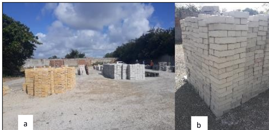
Figura 4.19 – Armazenado das peças (a) e pavers em contato com o solo.
