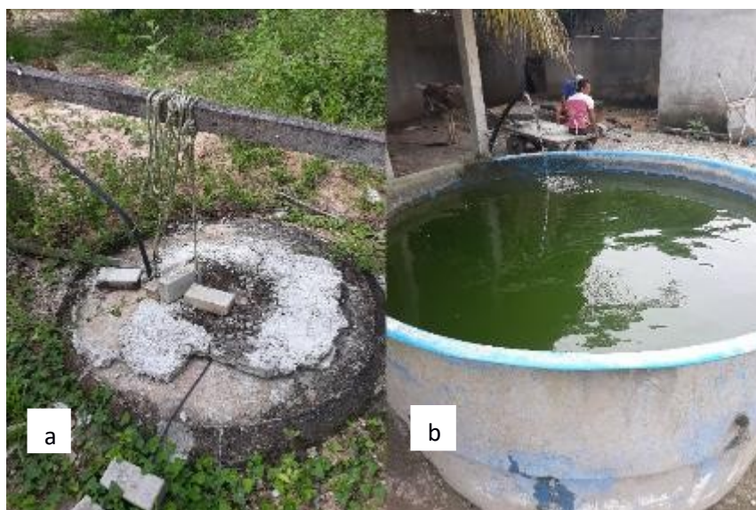
Figura 4.9 – Fonte da água de amassamento (a) e coloração esverdeada da água (b)
