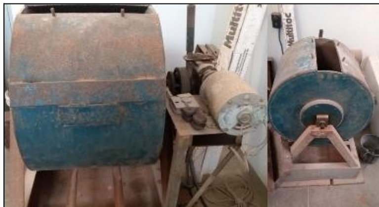
Figura 3.11 – Máquina “ Los Angeles ” vista fronta (a) e perfil (b).
