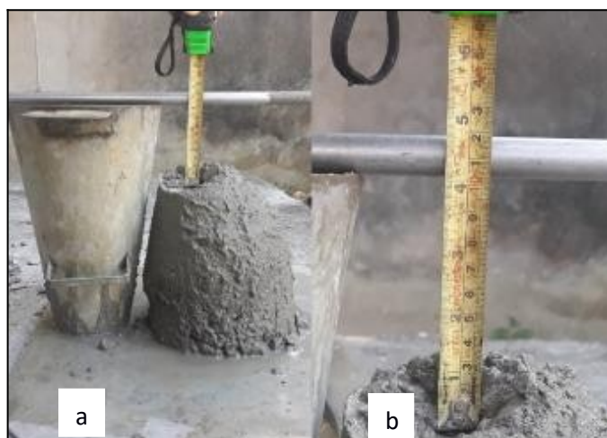
Figura 4.10 – Slump Test (a) e detalhe da medição (b).
