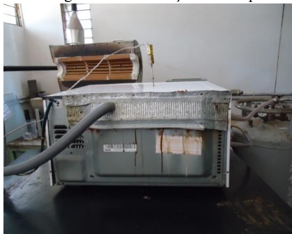
Figura 3.5 - Tubulação de Escape.
