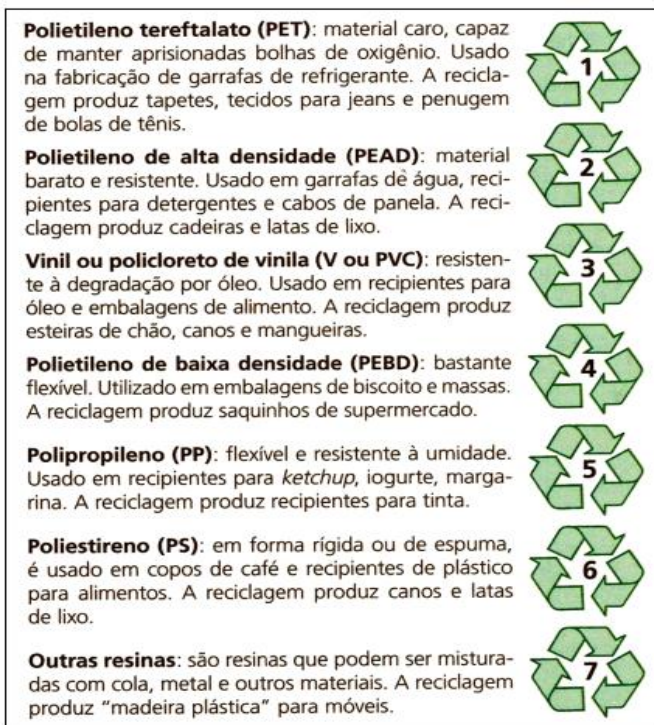
Figura 5 – Códigos de diferentes polímeros termoplásticos para facilitar a separação antes da reciclagem
