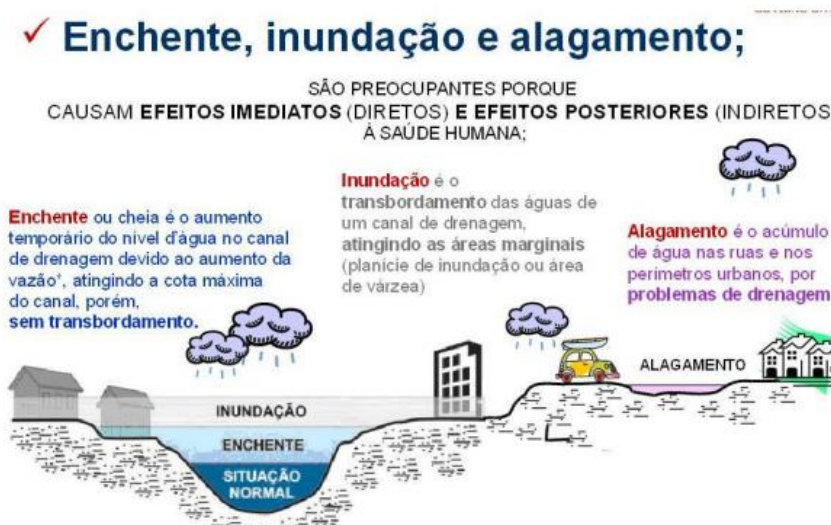
Figura 1- Alagamentos, inundações e enchentes
