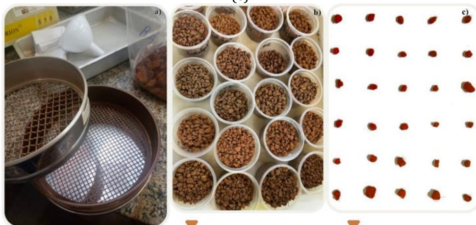
Figura 2 - Preparo das amostras: peneiramento (a), agregados de 4,76 mm -8 mm (b), disposição dos agregados em folha de sulfite para captura das imagens com aplicativo scanner de celular (c).
