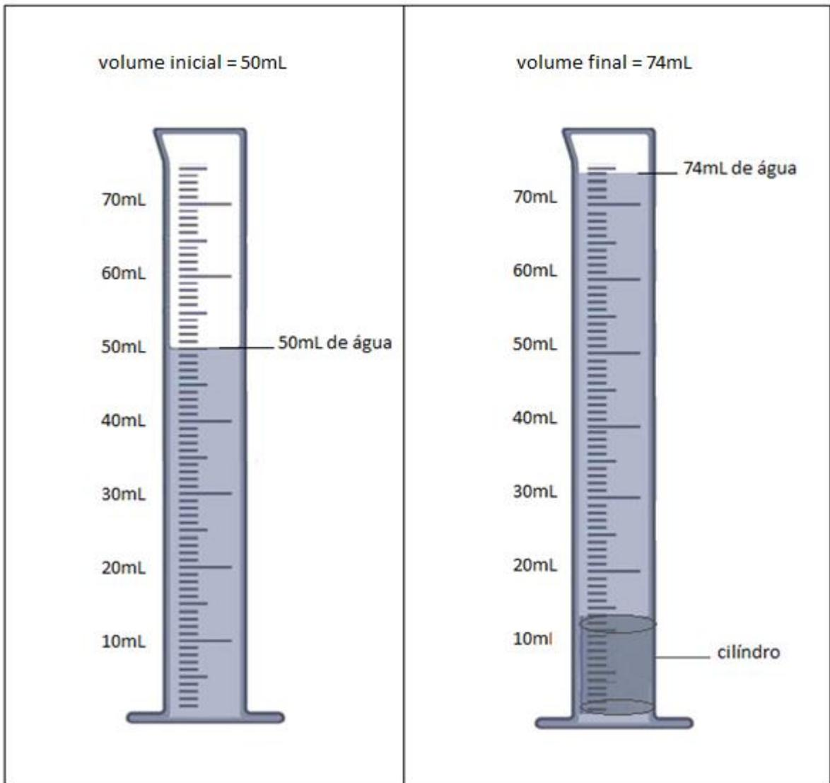
**Figura 3:** Experimento para determinação do volume dos metais.
