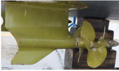
Azimut – Sem incrustações após 12 meses
