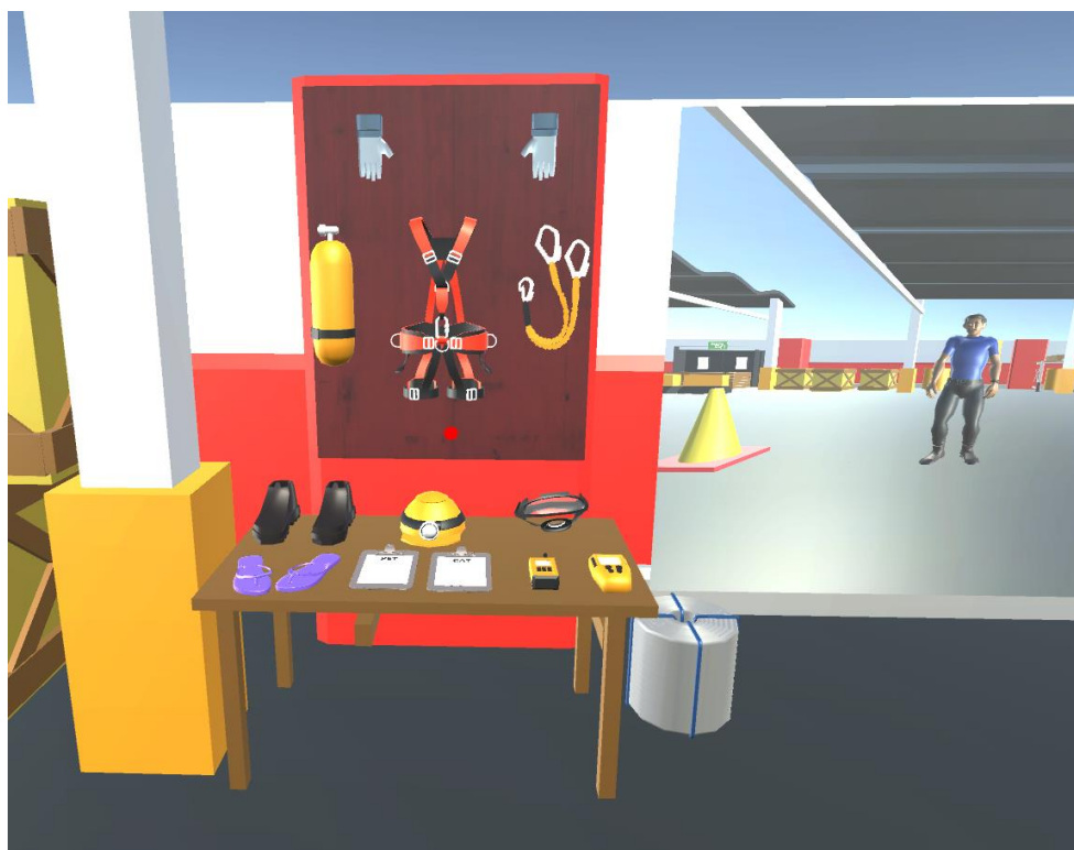
Figura 9. Tela dos equipamentos de proteção individual e dispositivos de segurança necessários para as atividades em espaços confinados
