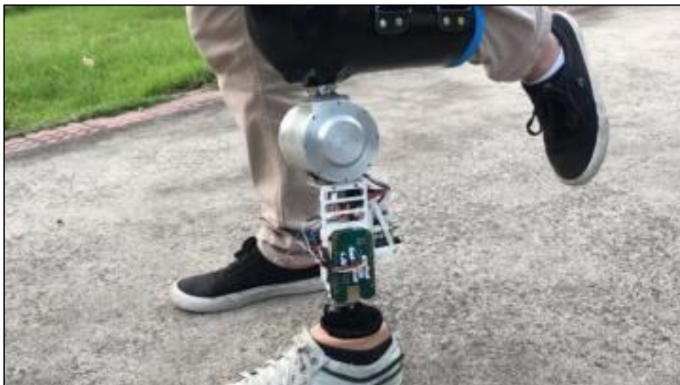
Figura 5 – Prótese Robótica Elaborada para Pessoas Amputadas
