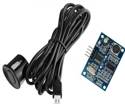
Figura 3: a) Sensor Ultrassônico JSN-SR04T 2.0 e Módulo para Arduino [9]. b) Instalação do sensor na Caixa Superior.
