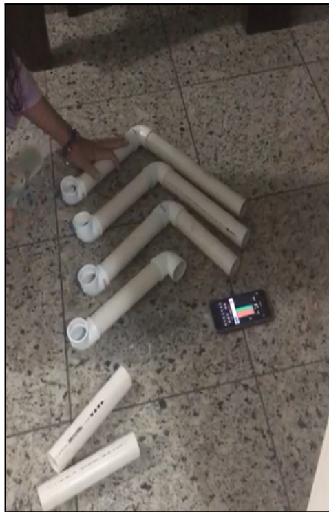
Figura 7: Montagem e teste da frequência do tubofone no app Tuner T1 Fonte: De própria autoria, 2023.
