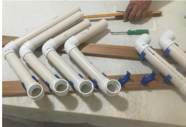
Figura 10 - Fixação dos tubos com braçadeira Fonte: De própria autoria, 2023.
