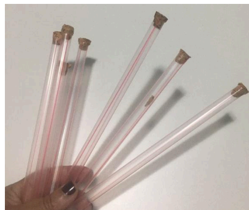
Figura 14 - Canudos após vedação feita com pedaços de rolha Fonte: De própria autoria, 2023.
