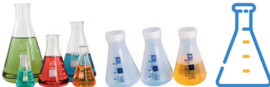
Figura 13: Erlenmeyers de (a) vidro borossilicato e de (b) polipropileno
