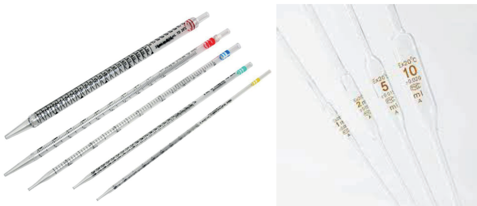
Figura 16: Pipeta de vidro (a) graduada e (b) volumétrica
