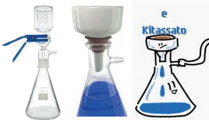
Figura 28: Conjunto de Kitassato e funil de Buchner
