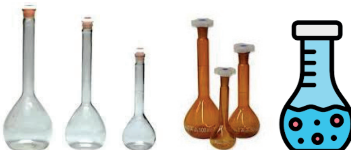
Figura 14: Bal es volum tricos de vidro com diferentes capacidades de volumes
