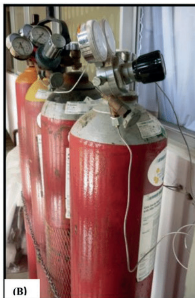
Figura 79: (a) Tubos e conexões de aço inox e cobre (b) cilindro dos gases empregados em CG
