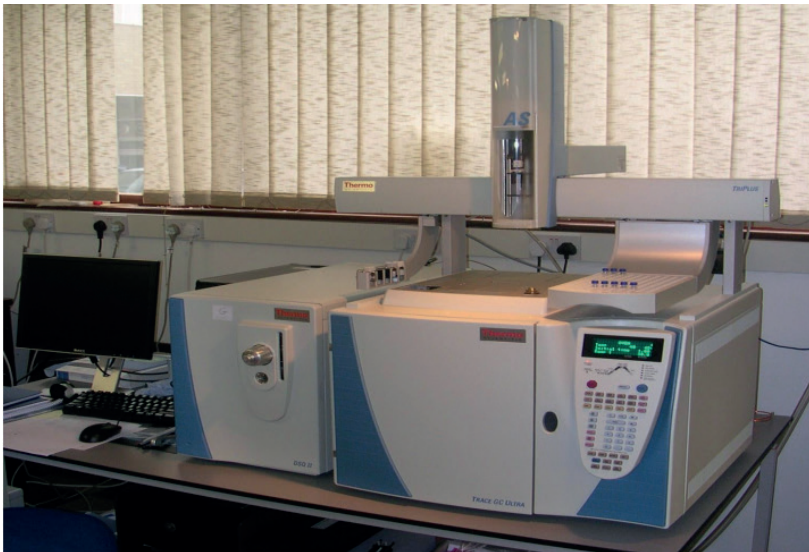
Figura 81: Exemplo de um CG acoplado a Espectrometria de Massas (MS)
