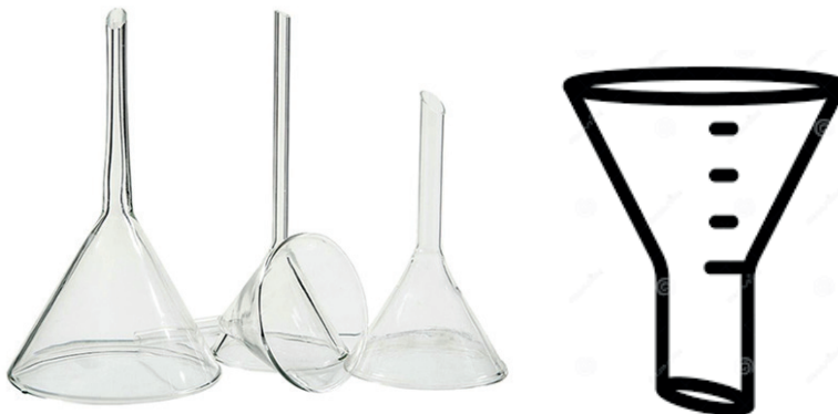
Figura 18: Modelos de Funis Analíticos de diferentes tamanhos
