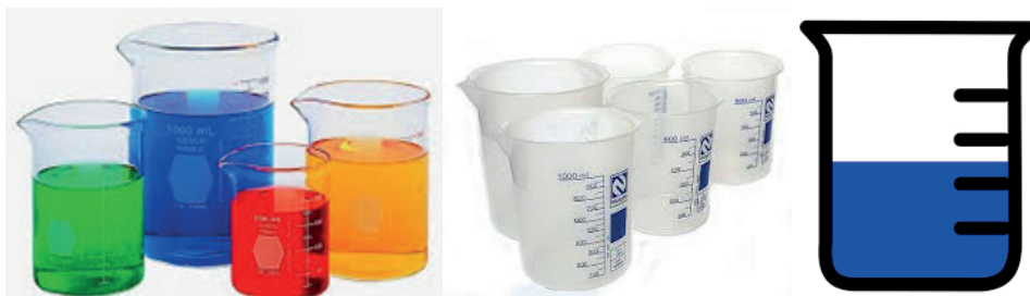
Figura 12: Frasco b quer de (a) vidro borossilicato e de (b) pl stico
