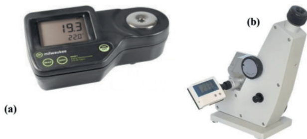
Figura 85: Refratômetro (a) digital de bancada, (b) tipo ABBE de bancada.
