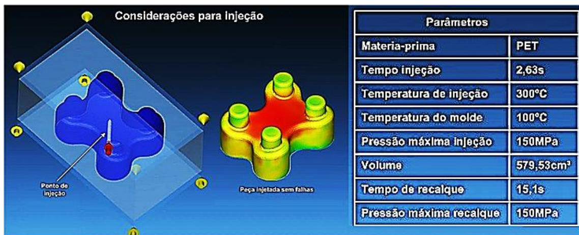
Figura 1. Parâmetros para simulação computacional no modelo de peça e moldes mecânicos da pesquisa.
