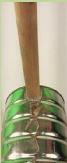
Figura 7 - Encaixe do cabo de madeira no furo da lata.
