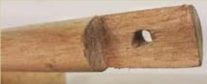
Figura 5 - Furo com broca 10 mm.
