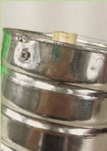
Figura 8 - Fixação da corda de violão na lata.
