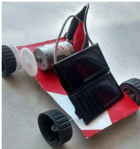
Figura 13 - Protótipo de carrinho solar.
