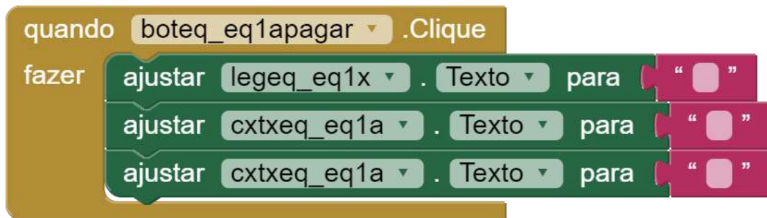
Figura 37 - Bloco que executará: ao clicar em "Apagar" apagará todos os textos inseridos
