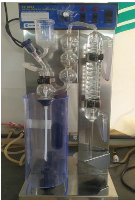
Figura 18 – Aparelho destilador Kjeldahl tradicional
