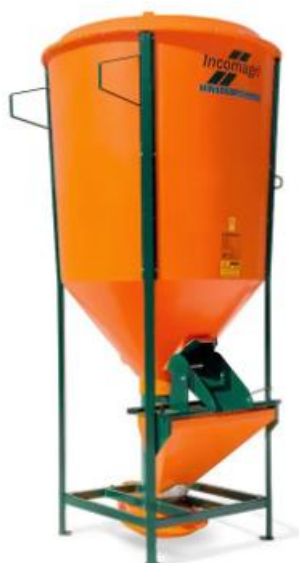
Figura 56 – Misturador vertical utilizado em fábrica de ração de pequeno porte. Disponível em:
