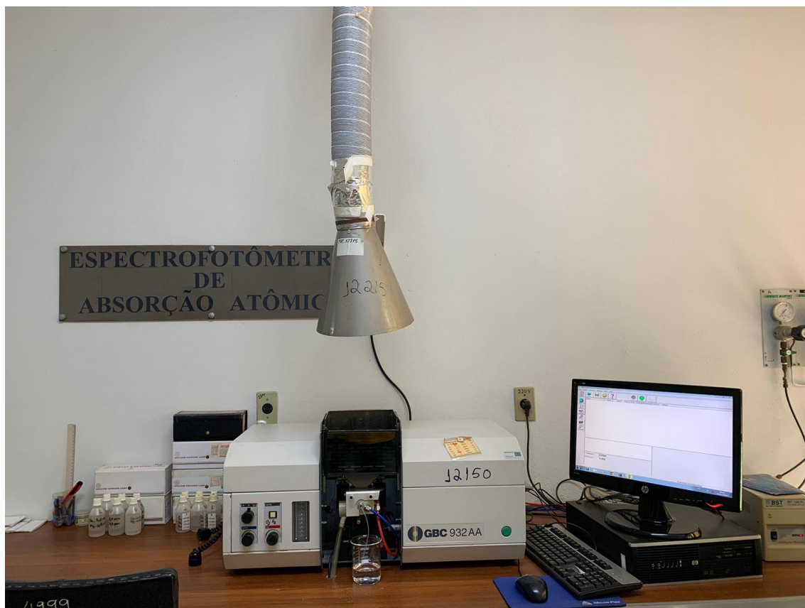
Figura 32 – Aparelho de espectrofotometria de absorção atômica utilizado em laboratório de análise de solos do IFMG Campus Bambuí
