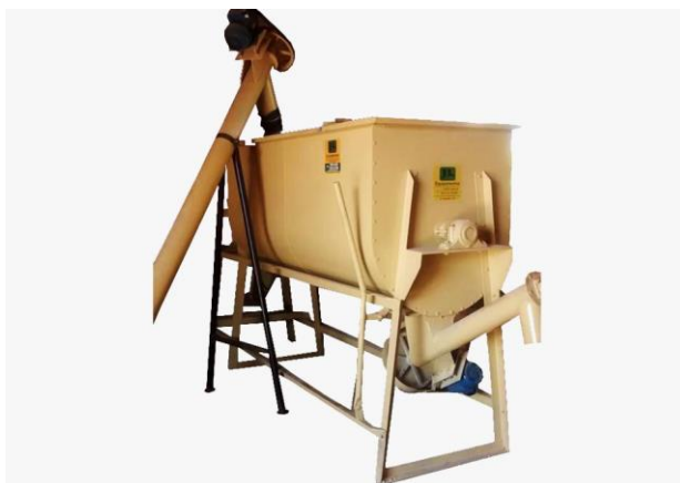
Figura 55 – misturador horizontal utilizado em fábricas de ração. Disponível em:
