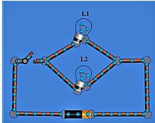
Imagem 5 – Duas lâmpadas associadas em paralelo num circuito com uma bateria e um interruptor.
