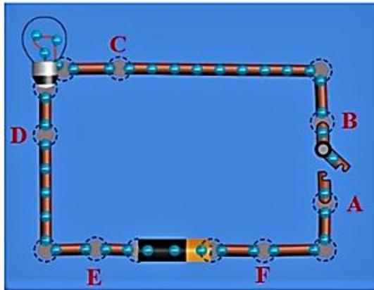
Imagem 3 – Circuito elétrico simples com uma lâmpada.
