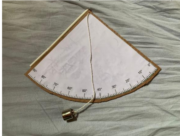
Figura 1 - Quadrante feito com papelão, canudo, graduação impressa, linha e peso de prumo.
