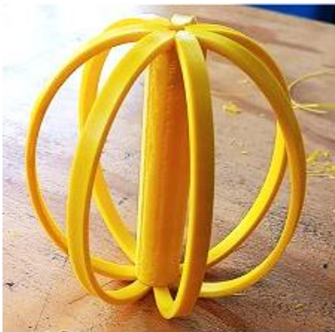
Figura 14. Peças fabricadas em 3D referentes ao conjunto de bobinas toroidais junto com o transformador de aquecimento ôhmico central.
