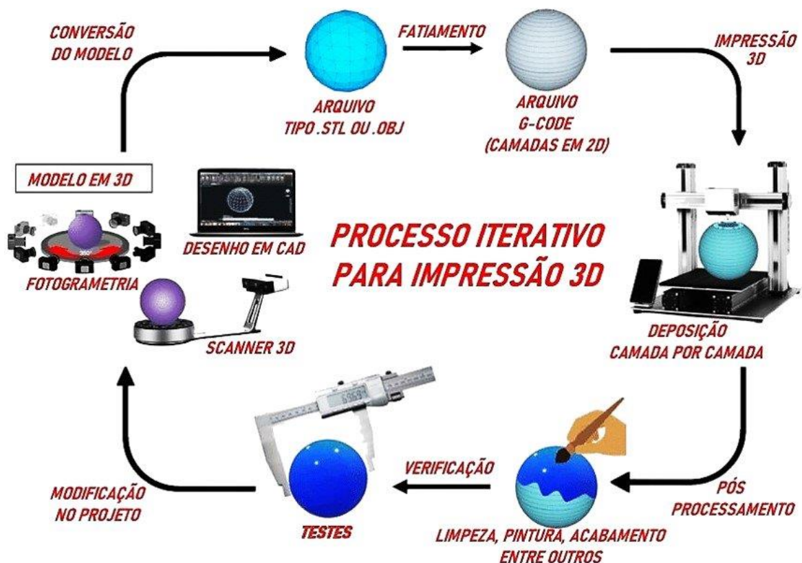
Figura 01. O processo completo de fabricação em manufatura aditiva (impressão 3D). Fonte: Wiltgen et al. (2023).
