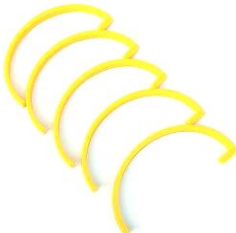
Figura 11. Peças fabricadas em 3D referentes às bobinas de campo magnético toroidal internas. (detalhe construtivo, estas bobinas não estão completas dado a técnica de montagem).
