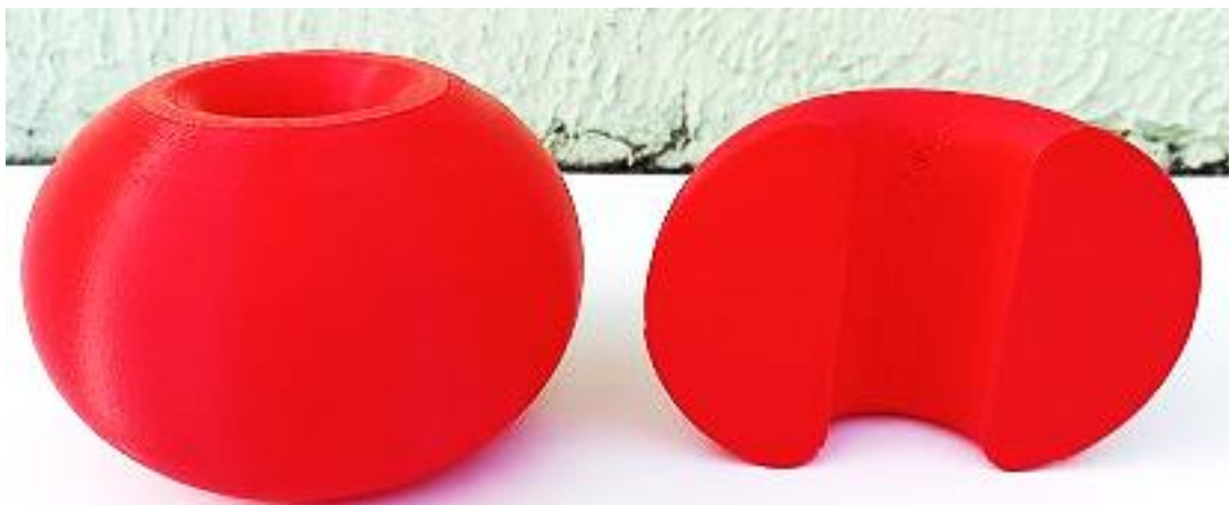
Figura 13. Peças fabricadas em 3D referentes ao formato de plasma de pequena razão de aspecto (completo e pela metade, mostrando a secção “D” do plasma).
