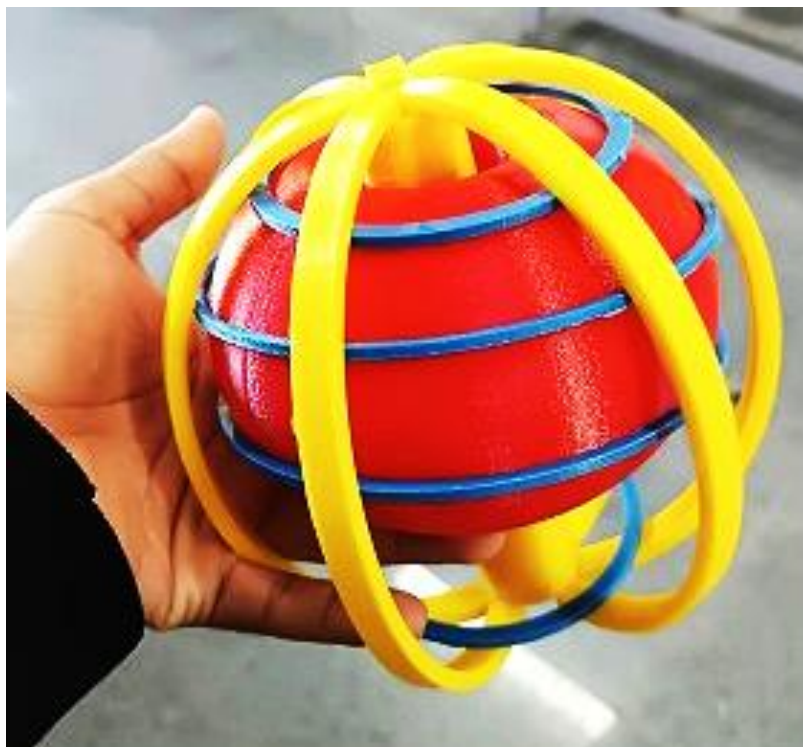
Figura 7. Peças fabricadas em 3D referentes ao a montagem final do Tokamak (proporção). Fonte: Próprios Autores (2023).
