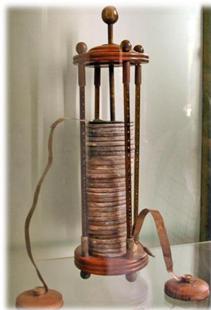
Fotografia de uma pilha de Volta.
