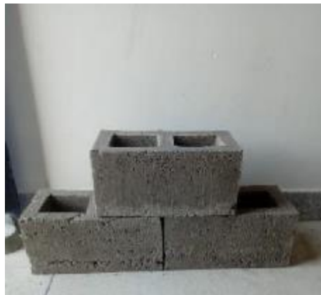
Figura 8: Blocos de concreto confeccionados
