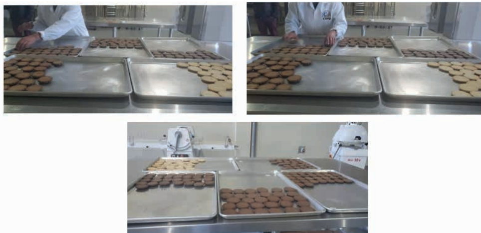
Figura 02: Proceso de enfriado de las condesas para su posterior empaclado.
