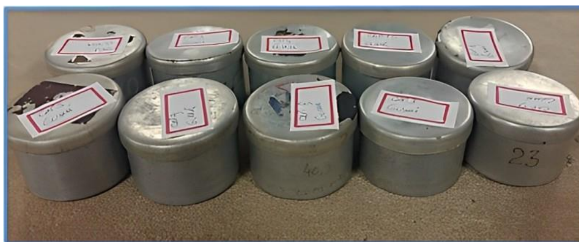
Figura 3 - Cápsulas de alumínio levadas à estufa para secagem contendo amostras de agregado
