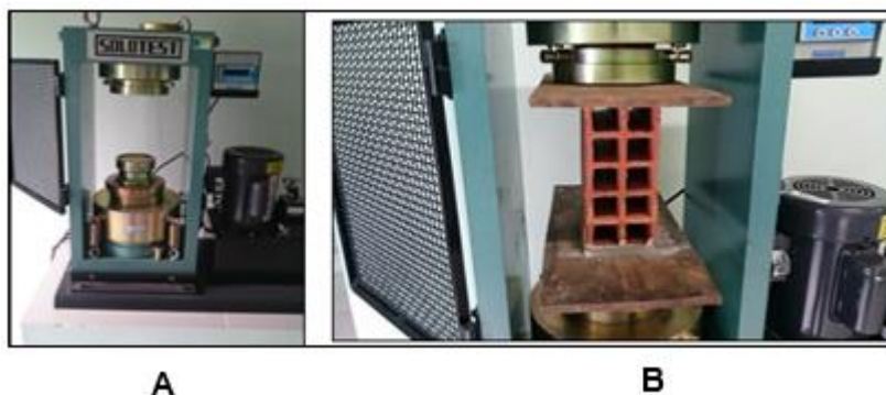
A B Figura 03 – A – Prensa com indicador digital; B – Ensaio de resistência à compressão do tijolo
