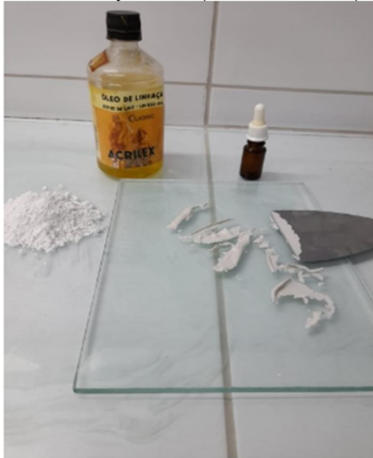
Figura 1- Teste de absorção de óleo (Carbonato de Cálcio precipitado)
