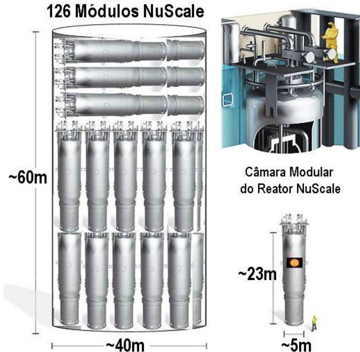
Figura 2. Pequenos (mini e micro) reatores a fissão nuclear. Comparação entre um vaso de pressão tradicional de um reator a fissão nuclear e um vaso de pressão de um pequeno reator a fissão nuclear modular do tipo NuScale .
