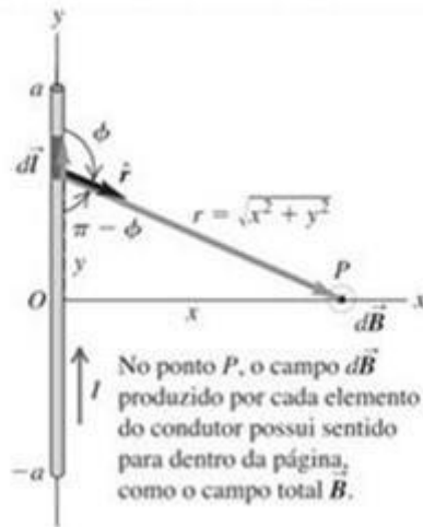
Figura 9 - Campo magnético produzido por um fio que conduz uma corrente.
