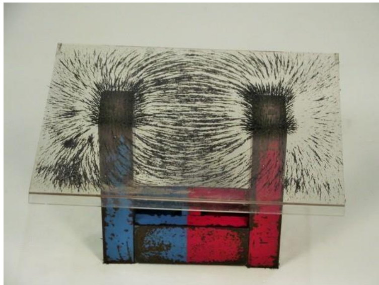
Figura 2 – Limalhas de ferro orientadas pelo campo magnético do ímã.
