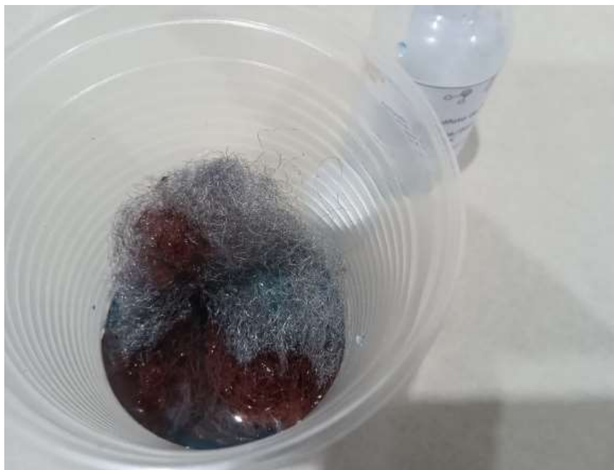
Figura 14: Redução do íon cobre na palha de aço
