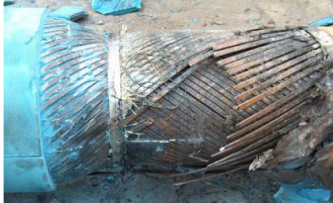
Figura 2 – Falha de arame de tensão durante serviço
