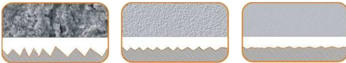
Fig. 6.3: Rugosidades em superfícies. Fonte: [http://www.psanticorrosao.com.br/jateamento\\_abrasivo.html](http://www.psanticorrosao.com.br/jateamento_abrasivo.html) (adaptada)
