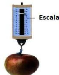
**Fig. 4.10:** Dinamômetro de mola. Fonte: [http://crv.educacao.mg.gov.br/sistema\\_crv/index.aspx?ID\\_OBJETO=108033&tipo=ob&cp=996633&cb=&n1=&n2=M%EF%BF%O](http://crv.educacao.mg.gov.br/sistema_crv/index.aspx?ID_OBJETO=108033&tipo=ob&cp=996633&cb=&n1=&n2=M%EF%BF%O)
