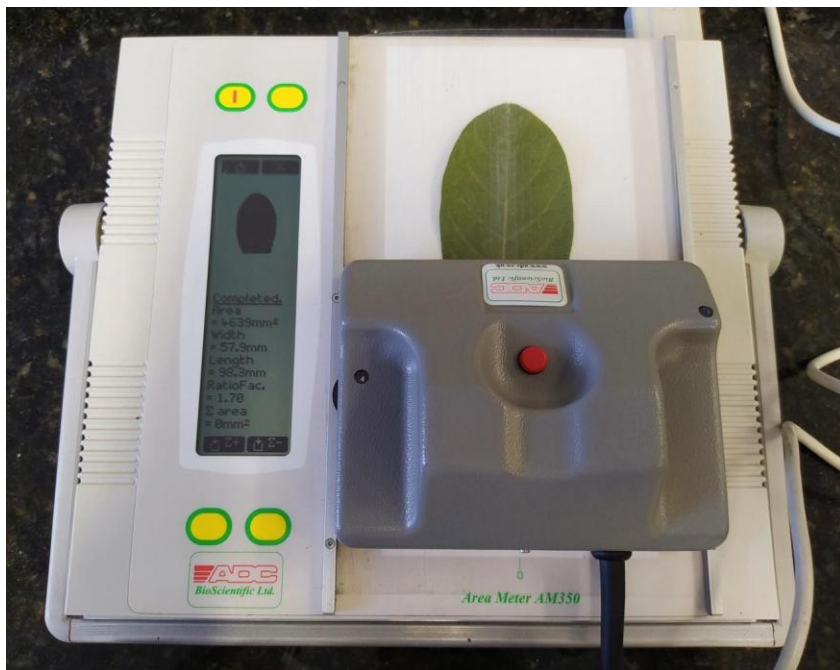
Figura 4 - Medidor de área foliar AM350 com uma folha de araquá ( Psidium cattleianum Sabine) em processo de medição da área foliar (foto sem escala).
