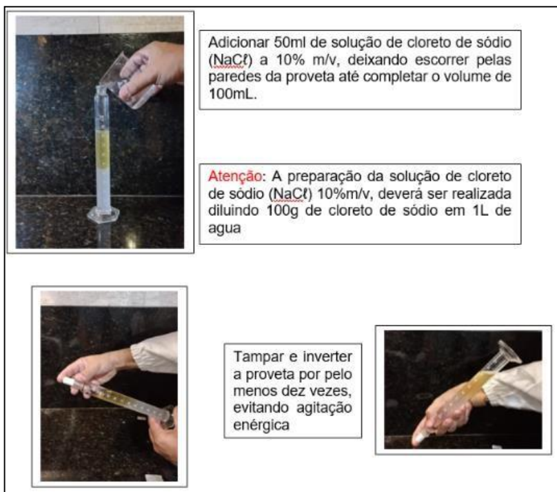
Figura 2 – Demonstração da adição da solução aquosa de 10% de NaCl.
