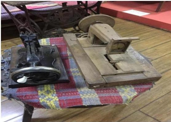
Figura 4- Máquina de costurar de ferro e de madeira;
